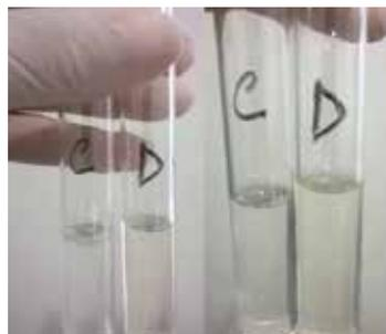
Figura 7 - Amostra dos sabonetes líquidos infantis C e D antes e depois do teste de centrifugação, respectivamente
